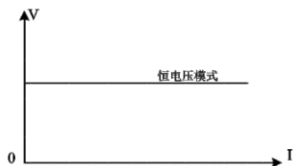
图 5-2 CV 模式电压电流关系图
